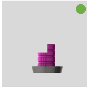
Base titanio SHe plat. 5 ● BTE.5000 ● BTE.5000.R Ti Base 5 alt. 1,2 Dimensiones P5 D5,5 A1,2 C4
