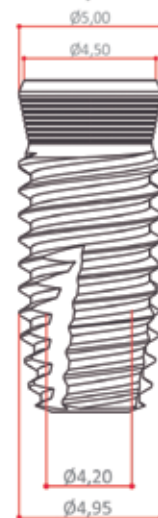
IMPLANTE SHi cortical \varnothing 5,00 Plataforma 5 - ancha
