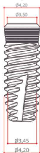
IMPLANTE SHi cortical \varnothing 4,20 Plataforma 4 - estandar
